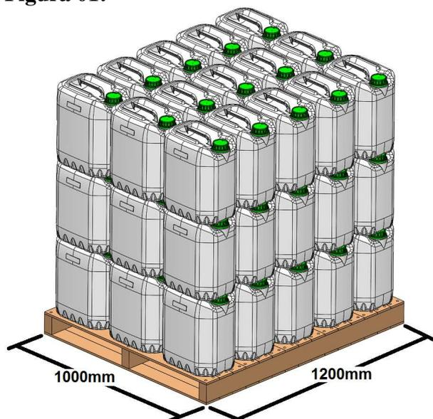
As embalagens devem ser empilhadas em piso nivelado, a distribuição de peso deverá ser uniforme e o palete deve ser de dupla face fechado ou lâmina rígida (papelão, PVC, etc). Conforme figura 01.
